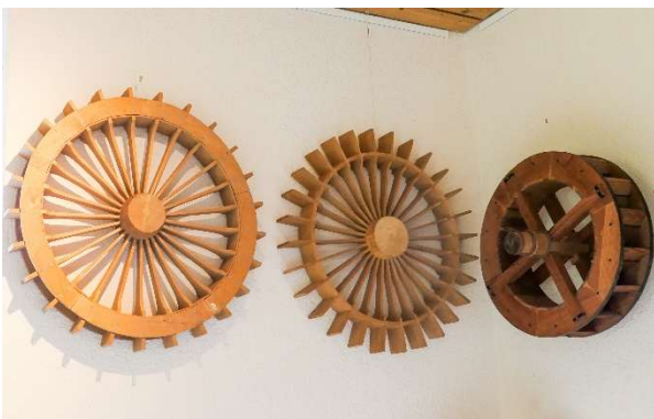
v.l.n.r.: Römisches Wasserrad mit geschlossenem Radkranz - Römisches Wasserrad mit offenem Radkranz - Mittelschlächtiges Rad
